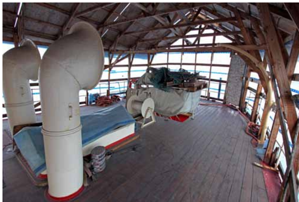
Sääkannen peräkannella (300) on muun muassa köysikela, teräsporras, kaksi ilmanottorvea ja skailetti, josta saadaan valoa konehuoneeseen (002) asti.
