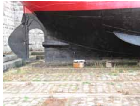
Laivan teräslevyjen niittejä hitsattiin, pohja ja kyljet hiekkapuhallettiin ja pohja maalattiin vuonna 2007. Kuvissa näkyvät laivan peräsin ja pallekölit.
