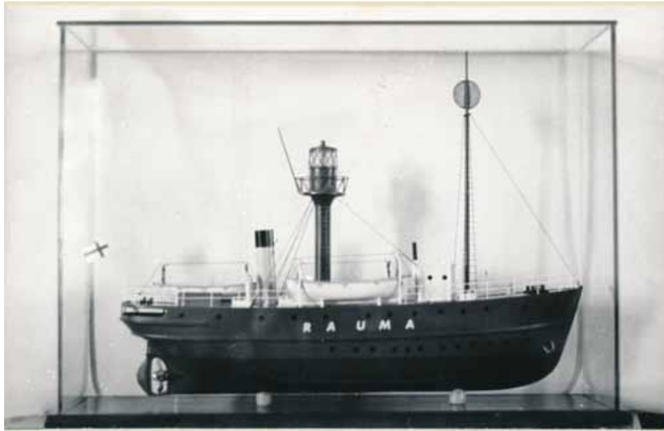
Majakkalaiva Rauman pienoismalli esittää laivaa vuosien 1933–1934 asussa eli ennen kuin merkkipallollinen keulamasto uusittiin pienemmäksi ja kevyemmäksi sekä merkkipallo poistettiin. Mallin omistaja ja mahdollisesti myös tekijä on ollut Ragnar Stackelberg, joka oli aluksen viimeinen päällikkö Raumalla. Kuvan lahjoitti Rauman merimuseolle Stackelbergin pojantytär Tiina Stackelberg-Kajantola. Kuva: RMM.
