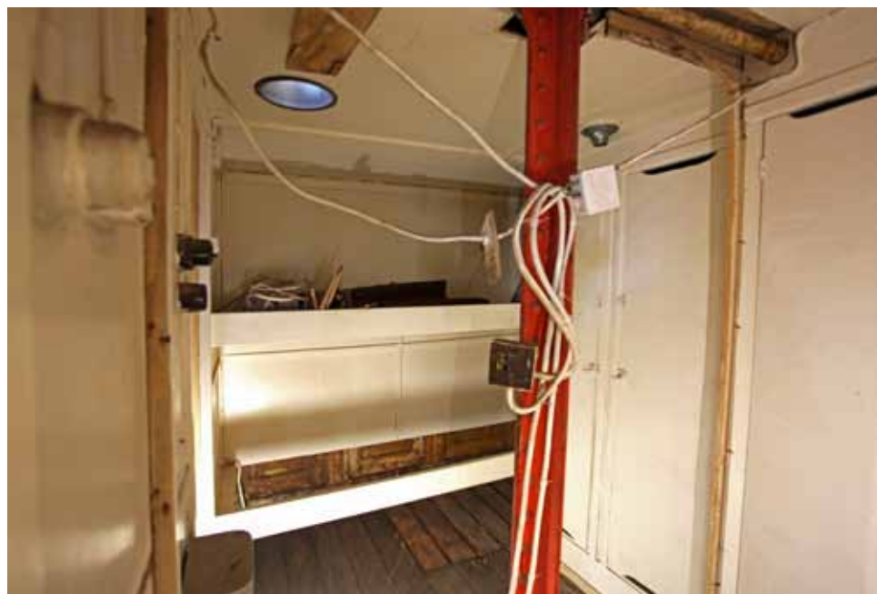
Luotsihyttien 211 ja 212 välinen seinä on purettu. Puretun seinän kohdalla on punaiseksi maalattu teräspilari, joka kannattelee sääkannella olevaa ruorihyttiä (302). Kumpaankin tilaan on oma ovensa ja molemmissa päissä on kerrossängyt.
