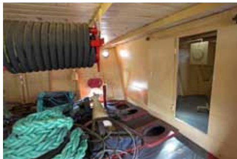
Kattoon on kiinnitetty paloletkukela. Lattiassa näkyvät klyyssiputkien aukot. Keulanpuoleinen oviaukko vie miehistön pesuhuoneeseen (214).
