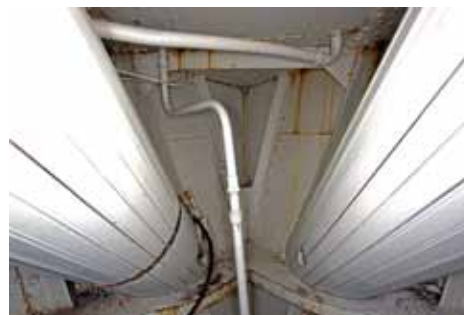
Ankkurikettinkien klyssiputket kulkevat vinottain keulavaraston (112) läpi.
