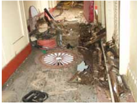
Pääkannen käytävä ja sen vanhat, huonokuntoiset kansilankut vuonna 2007.
