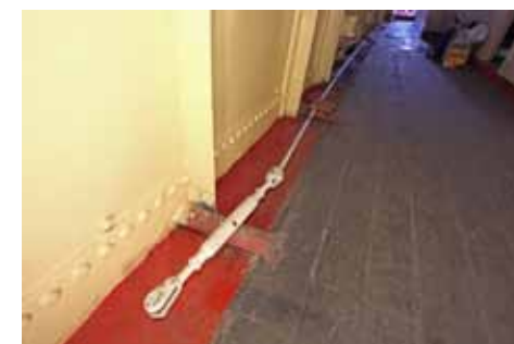
Ruurin peräsimeen yhdistävät vetotangot kulkevat käytävän ulkolaidalla.
