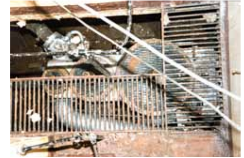
Höyrykoneen yläpuolella (201) oli ennen kunnostustöitä pääkannen tasolla teräksiset kulkusillat. Kuva: SMK / MV.
