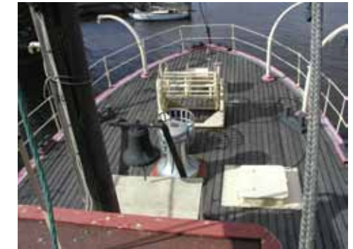
Näkymä ruorihtin (302) katolta kohti sääkannen keulaa eli etukantta (303), jolla näkyvät muun muassa laivakello, köysikela ja ankkuripeli.
