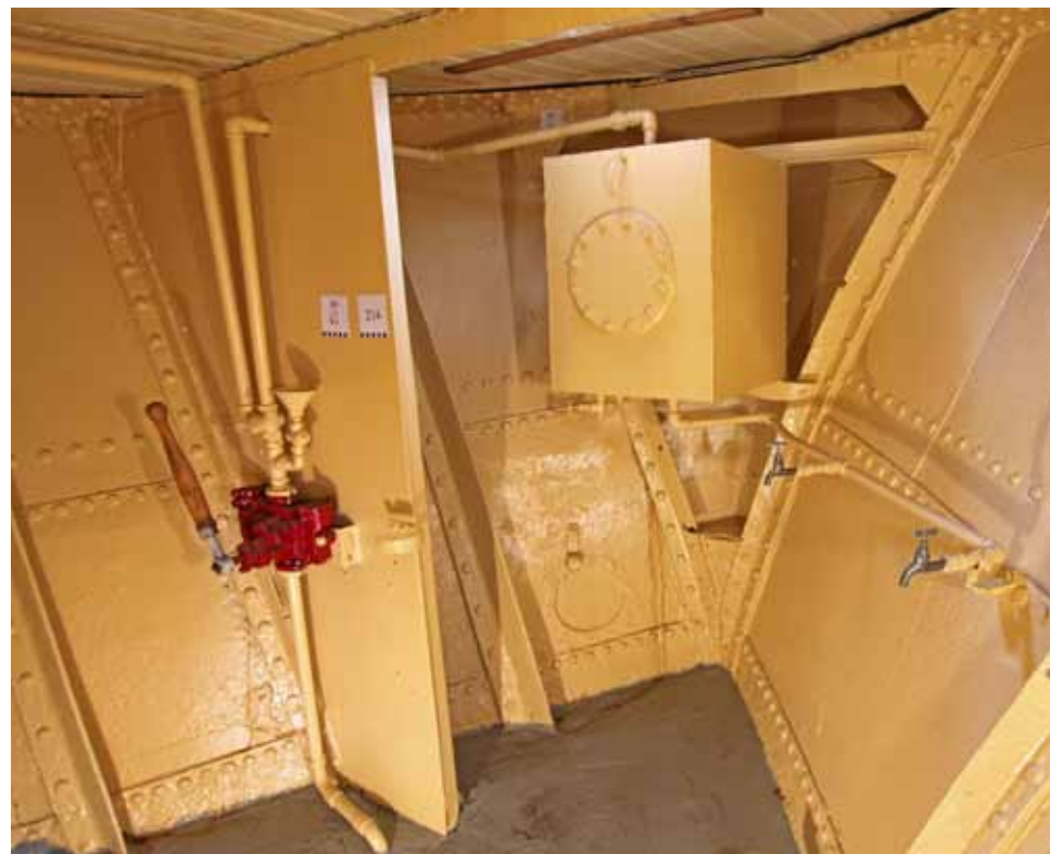
Miehistön pesuhuoneeseen (214) pumpattiin merivettä punaisella käsipumpulla.
