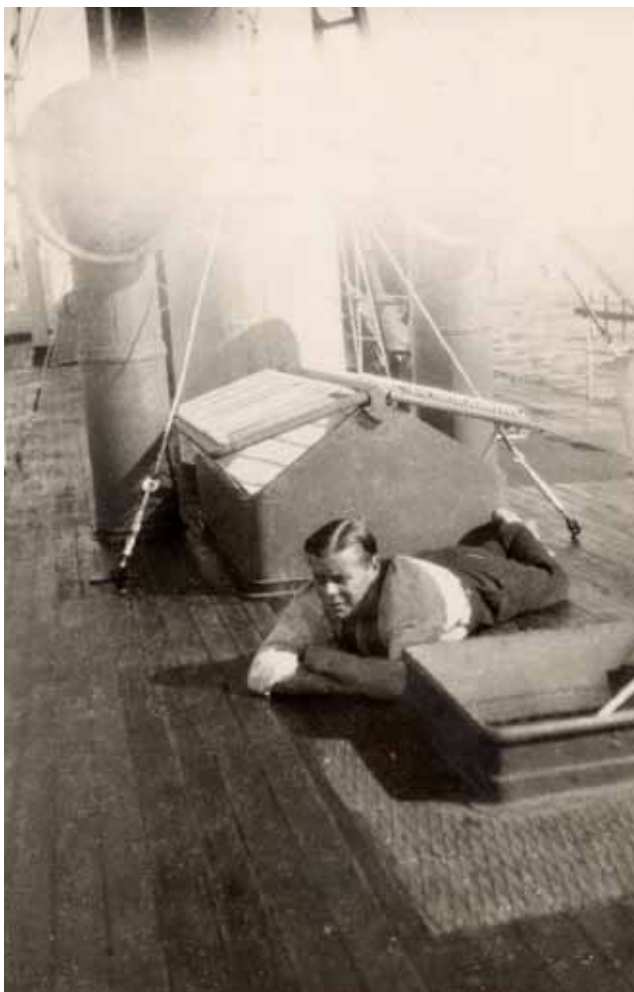
Sääkannen peräosan alas johtavan portaan aukko näkyy oikealla. Kannella makaavan miehen takana ovat konehuoneen yläpuolinen skailletti, korsteeni ja raakitortvet.
