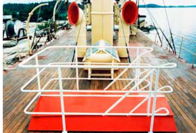
Kemin sääkansi kunnostuksen jälkeen. Etuallalla on uuden, alas pääkannelle johtavan yleisöportaan kaide. Sen takana ovat skaietti, raakitorvet ja korsteeni.
