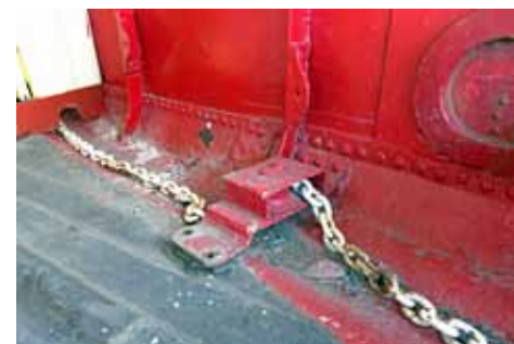
Ruorikettingit kulkevat laidoilla olevien ohjauksellisten läpi.
