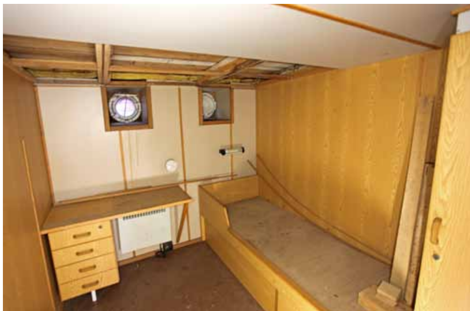
Tutkijahytin (107) paapuurin puolella on kaksi valoventtiiliä.
