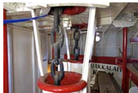
Ankkuriketungit kulkevat ankkuripelihooneesta (213) puutyöverstaan (110) läpi alas kettinkisäiliöön (006).
