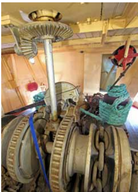
Ankkuripelin on valmistanut Clarke, Chapman & Co. Ankkuriketjujen liikuttelun lisäksi laitteisto pyörittää myös etukannella (300) olevaa käymäkela.
