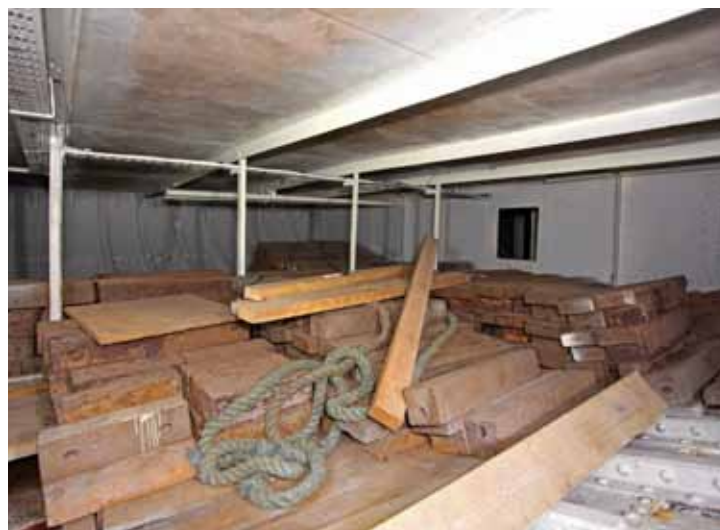
Ruuman (005) keulanpuoleisessa osassa on vanhoja valurautaharkkoja painolastina.
