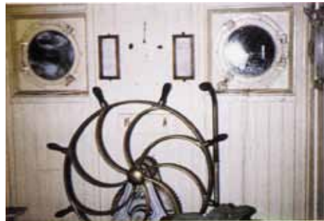
Ruorihytin pienet myrskykestävät venttiili-ikkunat on asennettu vuonna 1932, kun uusi teräsrakenteinen hytti valmistui. Ruorimies näki ulos vain seisossaan ruorirattaan sivulla. Kuva: Osmo Ranta-aho. Teoksesta Laurell 1988, 124.
