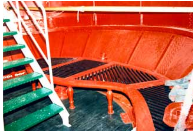
Vasemmalla ovat uudet sääkannelle nousevat vihreät teräsportaat. Aiempi porras oli kapea ja jyrkkä ja se kulki 180 astetta toiseen suuntaan. Pääkannen peräkannella (200) on kvadrantti, jonka päällä on punaiseksi maalattu, mustin ritilätasoin varustettu kaareva kansirakenne. Peräkannen sivuilla olevat aukot peitettiin pressuilla. Lipputanko on väliaikaisesti vielä poikittain tilassa. Sen istukka näkyy penkin takareunassa.
