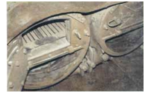
Höyrykattilassa poltettiin majakkalaivan toimintavuosien aikana yli 4 000 tonnia kivihiiltä. Kuva: Lennart Mustonen. Teoksesta Laurell 1988, 114.
