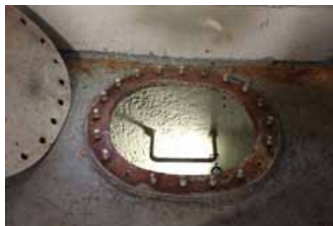
Painolastitankin (007) ahdas sisäänkäyntiluukku on hyttikannen vesivaraston (111) lattiassa.
