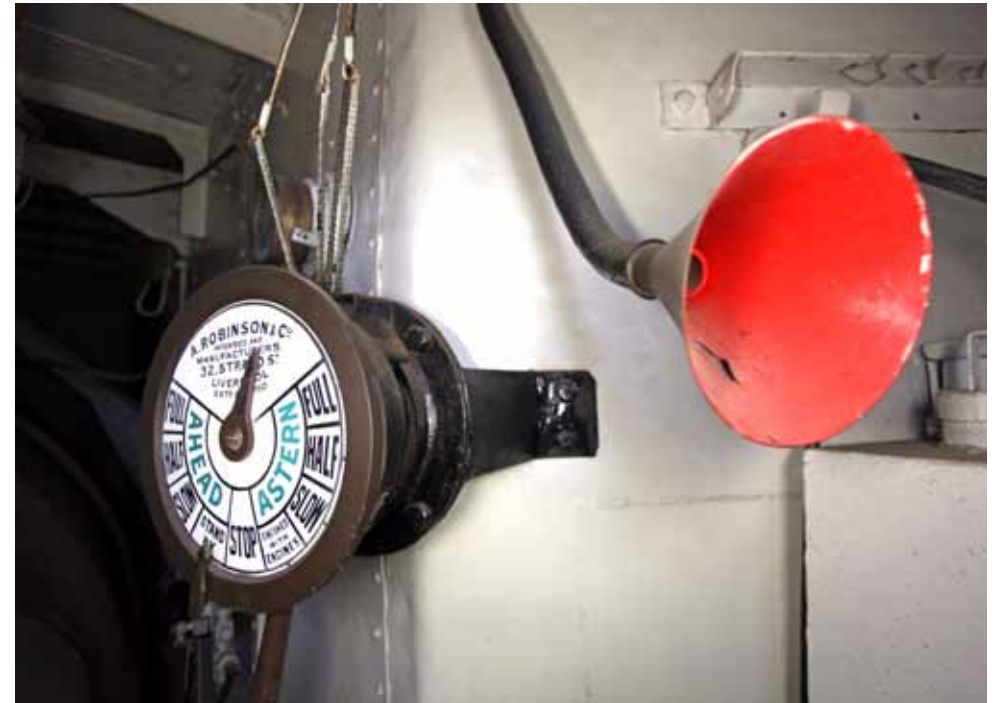
Konekäskyvälitin ja huutotorvi styrpuurin puolella. Ääni kulkeutuu torven kautta sääkannen ruorihyttiin (302).
