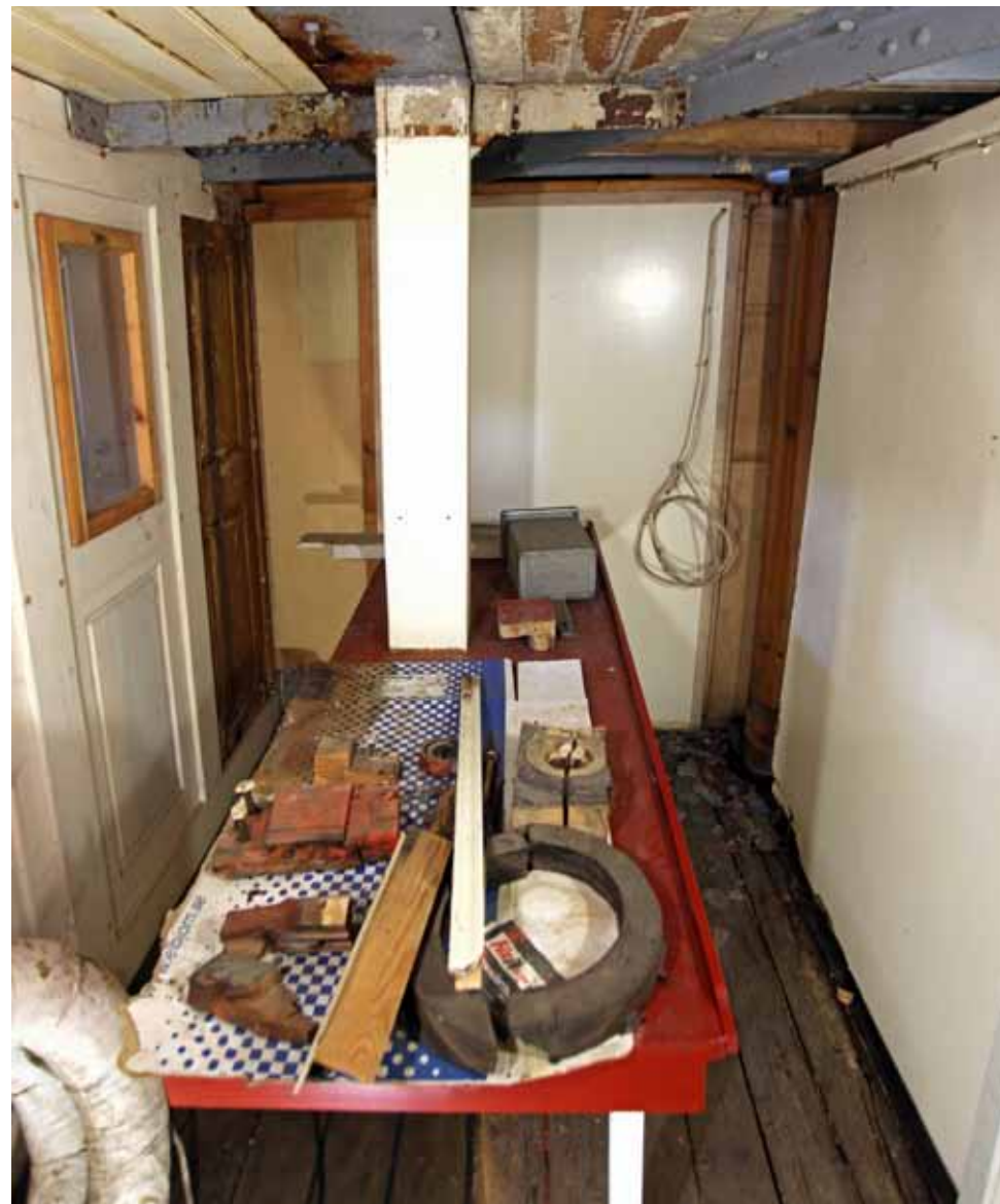
Messin (210) keskellä on ruorihyttiä tukeva koteloitu teräspilari.
