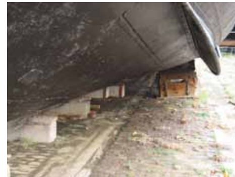
Laivan teräslevyjen niittejä hitsattiin, pohja ja kyljet hiekkapuhallettiin ja pohja maalattiin vuonna 2007. Kuvissa näkyvät laivan peräsin ja pallekölit.
