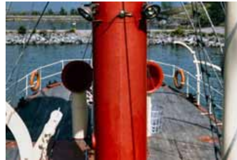
Sääkansi kohti perää. Kannella näkyvät höyrykonehuoneen ilmatorvet eli raakitorvet ja majakkatornin jalka.
