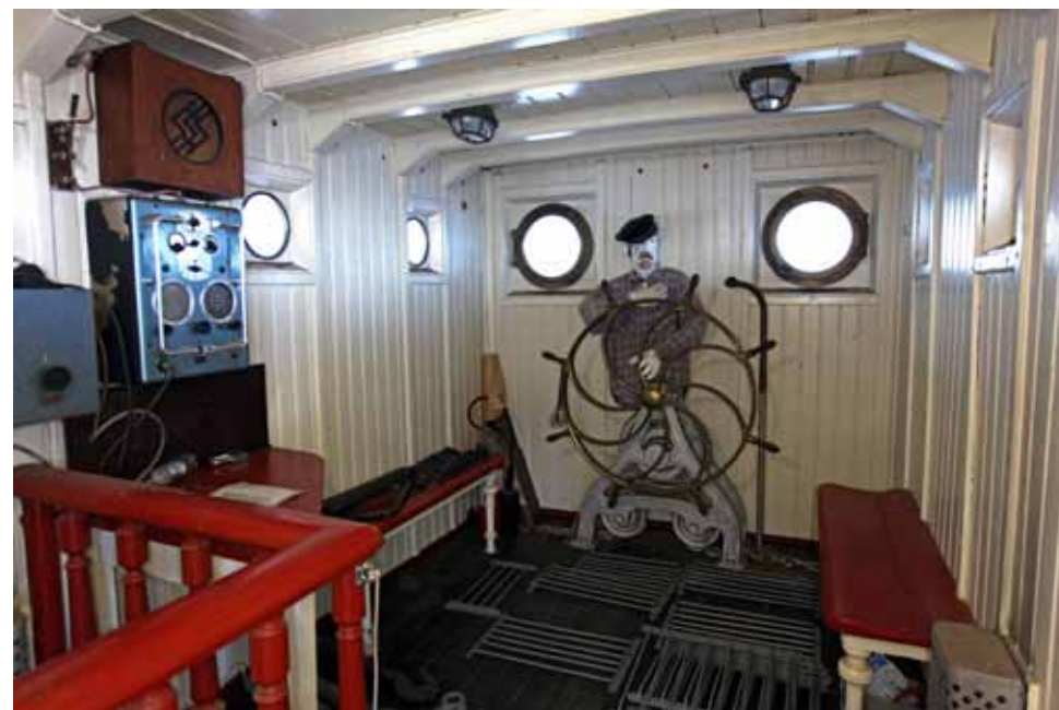
Ruorihytin (302) seinillä on vaaleaksi maalattu pystypanelointi ja valoventtiilit. Lattialla väliaikaisesti säilytettävät teräsritilät ovat skailettien suojaritilöitä.
