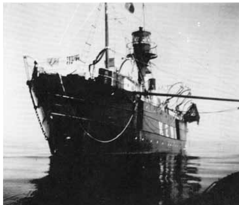
Majakkalaiva Kemi asemapaikallaan. Venepuomi on rikattu eli asetettu purkaus- tai lastaus-asentoon. Puomiin kiinnitetyn köyden avulla flengattiin luotsiveneeseen. Kuva: Job Heikkinen kokoelma. Teoksesta Laurell 1988, 111.
