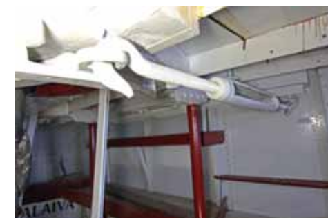
Raskasta kettinkiä ohjataan jykevillä vanttiruuveilla.
