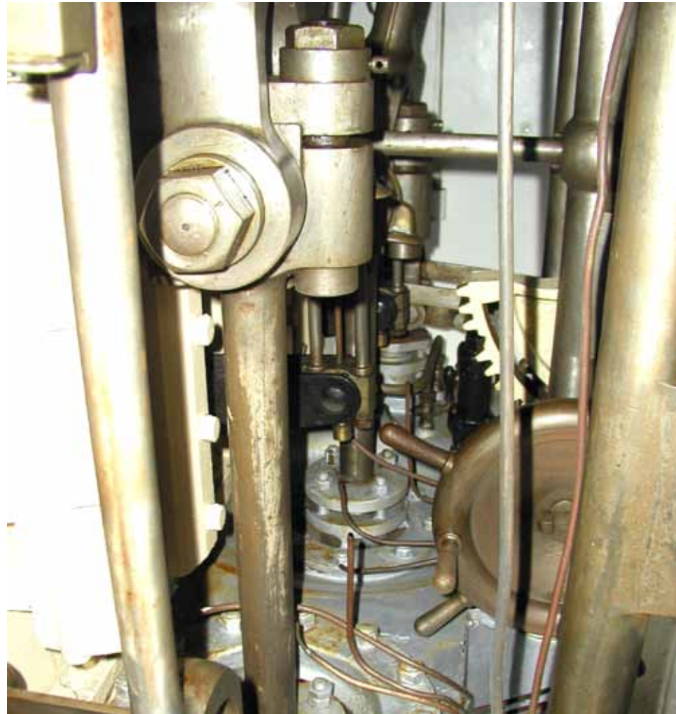
Konehuoneen (002) alkuperäinen compound-höyrykone.
