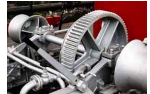
Voimansiirrin sääkannella majakkatornin takana.
