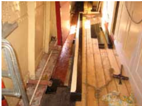
Pääkannen uusia männystä valmistettuja kansilankkuja asennetaan. Kuvat on otettu 5.11.2007.
