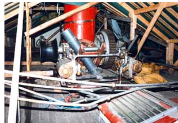
Sääkannen kuva on otettu Rauma-Repolan telakalla Savonlinnassa vuonna 1987. Keskellä näkyy majakkatornin punaista jalkaa. Oikealla on skailletti eli valoarkku, jonka päällä on teräspinnat. Kuva: SMK / MV.
