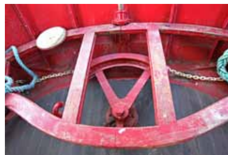
Peräsiimeen yhteydessä olevaa kvadranttia käännetään ruoriin yhteydessä olevilla ketjuilla.
