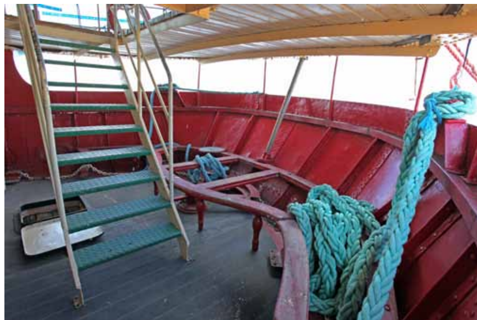
Pääkannen peräkansi (200) on laidoiltaan avoin. Keskelä on 1980-luvulla tehty teräsrakenteinen yleisöporras, jota kautta nouseaan sääkannelle. Lattiassa olevasta luukusta pääsee varastoon (001).
