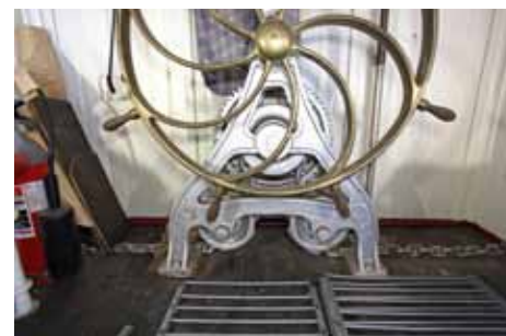
Ruorihytin (302) seinillä on vaaleaksi maalattu pystypanelointi ja valoventtiilit. Lattialla väliaikaisesti säilytettävät teräsritilät ovat skailettien suojaritilöitä.
