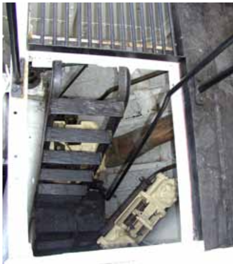
Terästikas johtaa pääkannelta alas kone- ja kattilahuoneeseen, joka sijaitsee pilssissä.
