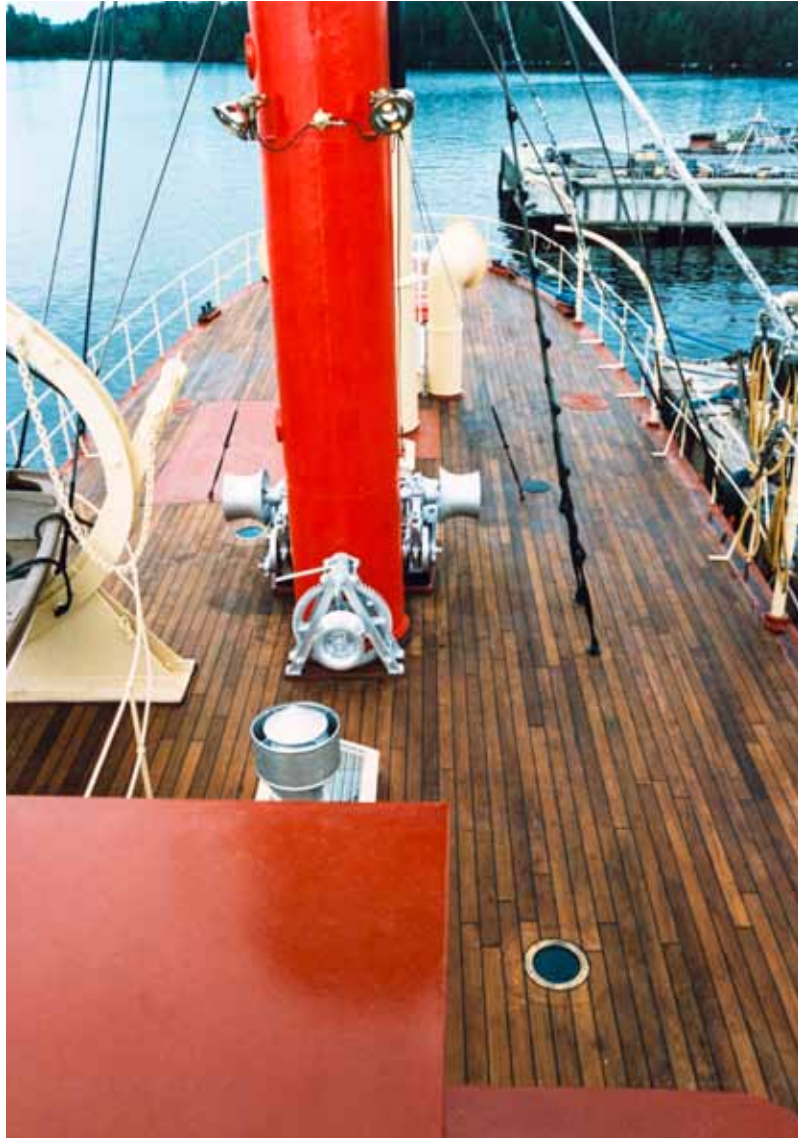
Sääkansi kuvattuna kohti perää. Kansi on pinnoitettu 11 mm paksulla teakilla. Punaiseksi maalatut hiilestysaukot sijaitsevat peräkannen molemmin puolin.
