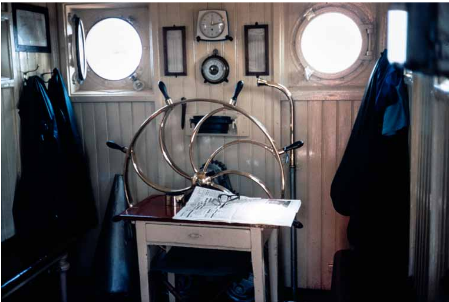
Sääkannen ruorihytti aktiivikäytön asussaan ja messinkinen ruori huolellisesti kiillotettuna.
